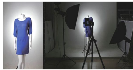
Bol standard : Plus profond que le bol beauté. Reproduit la lumière solaire. Modeleur contrasté à forte acutance (textures) les ombres sont denses. Délicat à positionner (précision) mesure de la lumière irréprochable.
